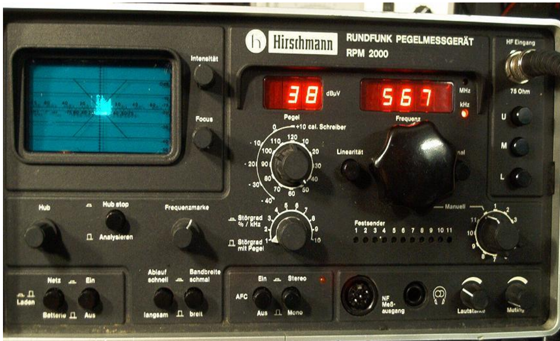
HF-Noise von 38dBuV@567kHz mit Antenne empfangen die weitab von den Störquellen ist! Antennenhöhe >10Meter
