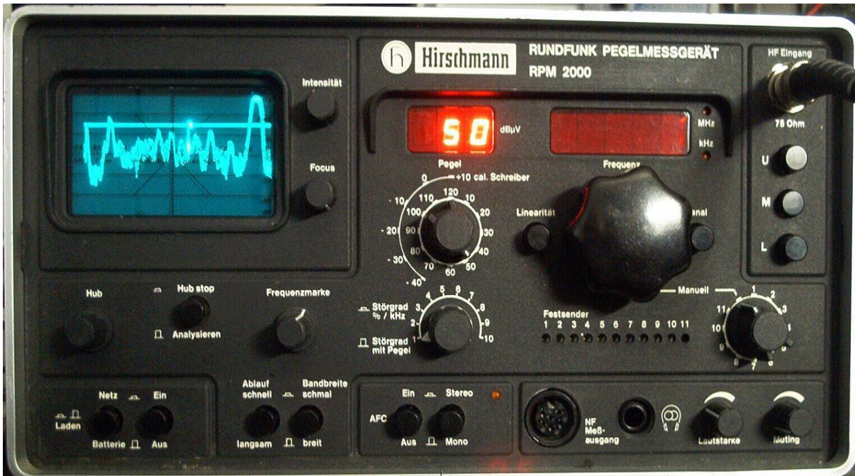
Hirschmann Rundfunk Pegelmessgerät RPM 2000 - Einstellung im unteren Mittelwellenbereich das linke Signal zeigt den DLF auf 549kHz die rechte Amplitude, das von dem 756kHz Sender. Die Display Line ist hier auf 50dBuV eingestellt, das bedeutet Signale die größer sind als die eingestellte Line übersteigen diese Signalstärke.
