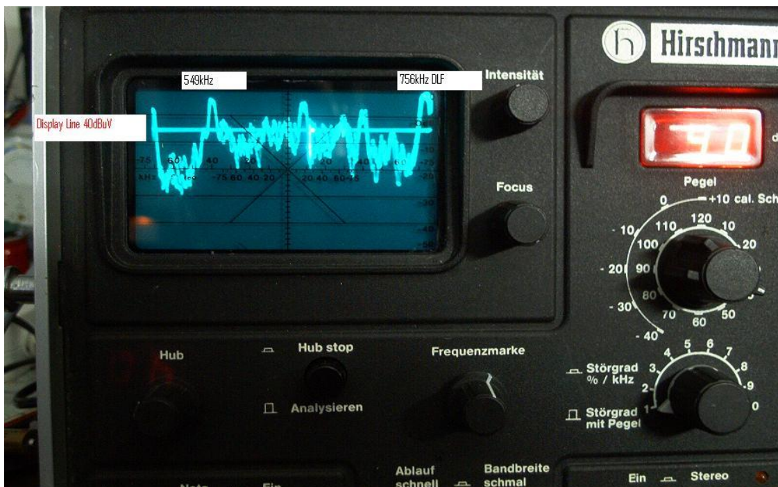
Bild 2 Darstellung der beiden DLF Frequenzen mit dem dazwischen liegendem Noise. Die Display Line ist dabei auf 40dBuV eingestellt, die Störsignale sind höher.
