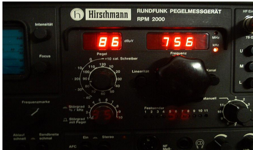
Bild 5 Deutschlandfunk auf 756kHz mit einem Signalpegel von 86dB \mu V!
